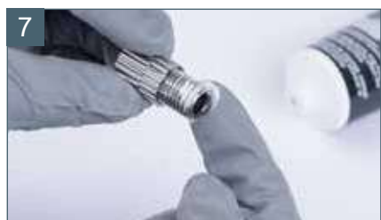
Смажьте резьбу винта-регулятора подачи материала
