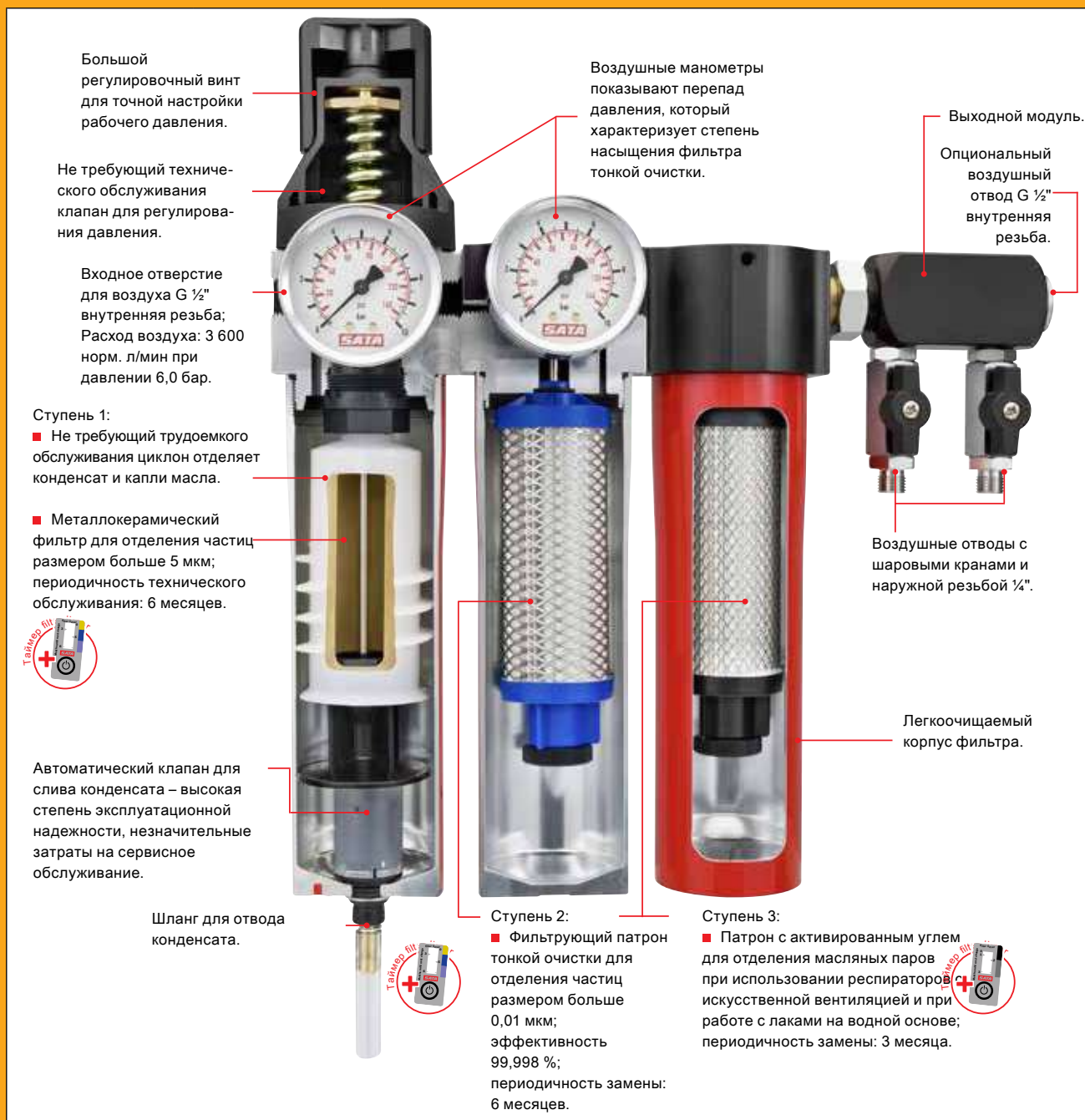
Модель SATA filter 484 в разрезе
