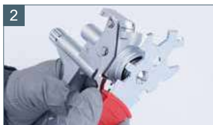
Затяните дюзу при помощи универсального ключа
