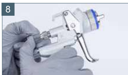
Установите винт-регулятор подачи материала
