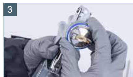
Установите воздушную головку
